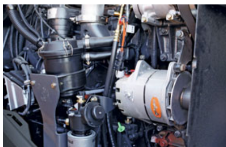
Filtr paliwa i punkty kontrolne oleju silnikowego są łatwo dostępne od obu boków, natomiast inne filtry znajdują się zaraz za prawymi schodkami.
