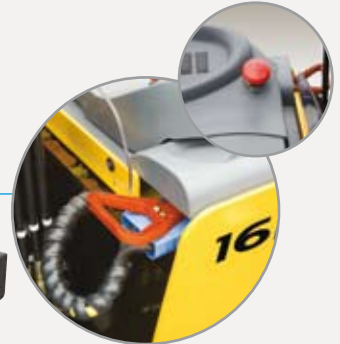
Hendel voor uitschakelen accuspanning & noodschakelaar
