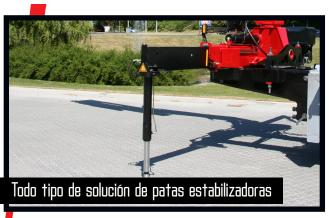
Las patas estabilizadoras de la grúa ofrecen estabilidad, pero deben ser fáciles de manejar y ocupar muy poco espacio, por lo que se pueden elegir entre patas estabilizadoras fijas, patas estabilizadoras abatibles manualmente 180° por medio de muelle de gas o patas estabilizadoras abatibles hidráulicamente 180°. Se puede elegir entre una viga extensible hidráulica o manual, también si la grúa está equipada con el avanzado sistema de supervisión de la estabilidad EVS.
