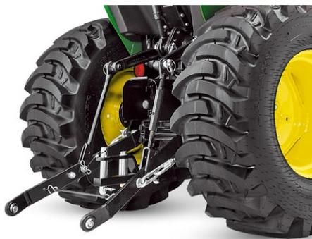
**Sollevatore posteriore a 3 punti di categoria 1:** elevata capacità di sollevamento per azionare un'ampia gamma di attrezzi.
