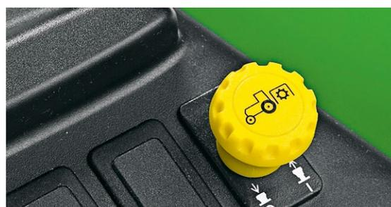
**PTO indipendente:** Dimenticate i giorni in cui era necessario fermare il trattore e innestare la PTO manualmente. Grazie alla PTO elettroidraulica potete azionare il vostro attrezzo con il trattore in movimento, portando a termine il lavoro in modo più semplice e veloce.
