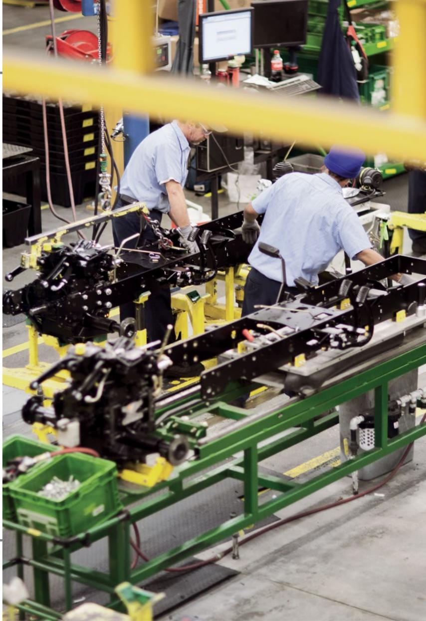
Due operai dello stabilimento di Augusta al lavoro per installare una trasmissione sul telaio in acciaio ad alta resistenza di un trattore compatto.
