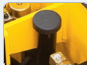
Vulopening van olietank
