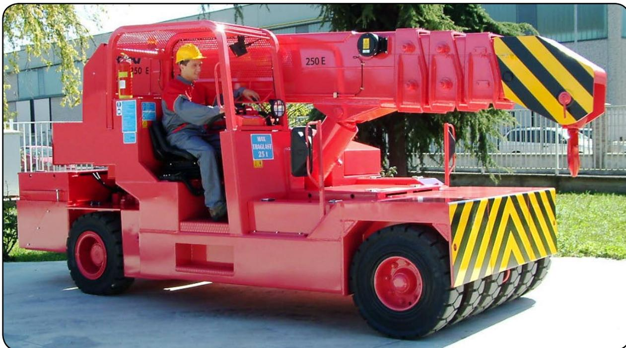
**TRAZIONE:** con motore elettrico DC Kw 28 - 96 V, autoventilato, reversibile, comandato da variatore elettronico di velocità a MOSFET con microprocessore.
