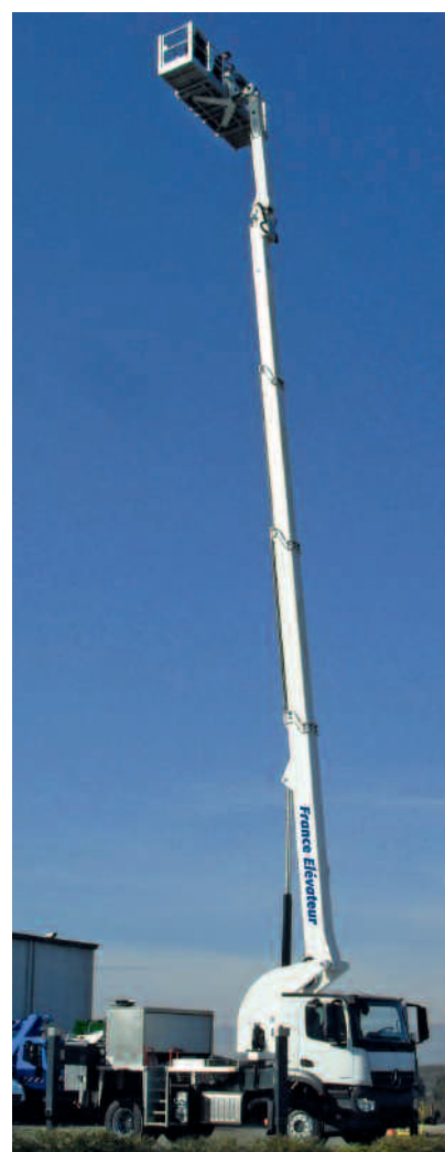
284 TBE sur porteur MERCEDES ANTOS avec barre anti encastrement
