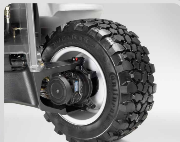
Moteur d'entraînement dans le moyeu 350
