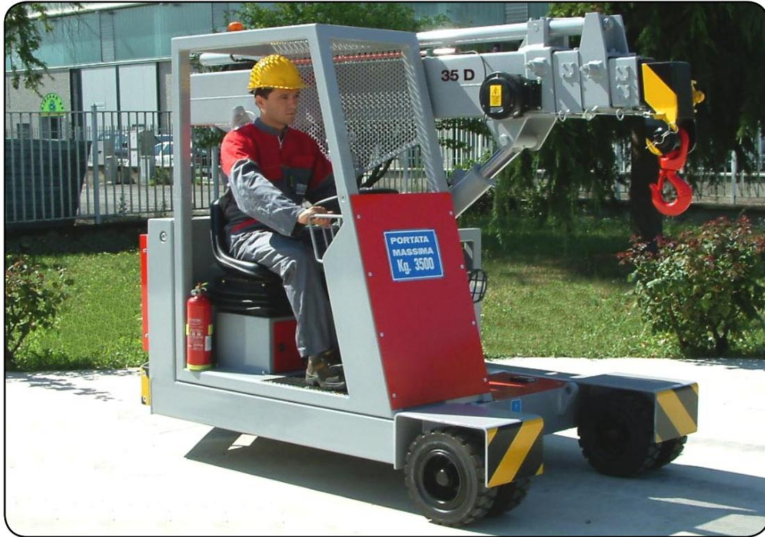
**MOTORE:** diesel 3 cilindri, raffreddato ad acqua, HP 22 - kW 17.
