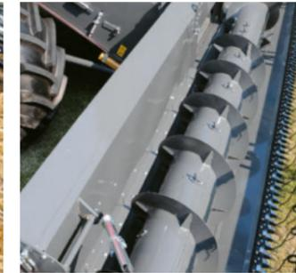
El rodillo alimentador Power Feed Roller - PFR conduce el cultivo de forma uniforme desde el cabezal al elevador de cultivo.
