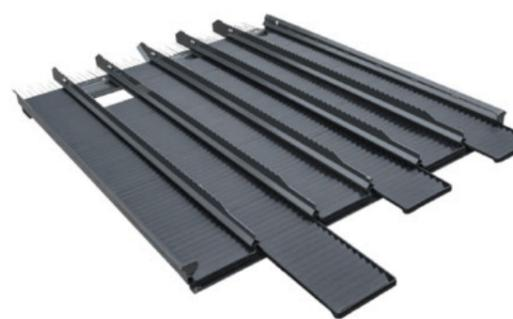
En condiciones de cosecha muy húmedas, una bandeja de preparación limpia garantiza siempre un alto rendimiento y una calidad óptima de trilla. Por este motivo, la bandeja de preparación de la Fendt Serie L se desmonta con facilidad y comodidad.
