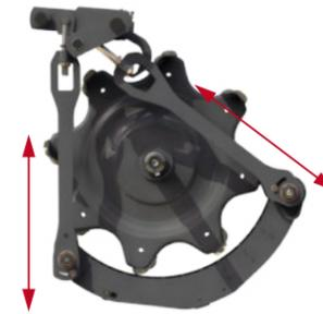
El cóncavo del separador se encuentra ubicado bajo el separador multicultivo (MCS). Este ajuste mejora el rendimiento de separación en condiciones de paja larga y húmeda, lo cual permite un alto rendimiento incluso en condiciones difíciles de cosecha.
