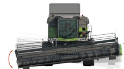
El control del cabezal AutoLevel estándar garantiza una altura de corte constante en toda su anchura.
