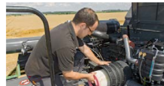
Czyszczenie filtra powietrza
