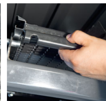
Extracción de las cribas
