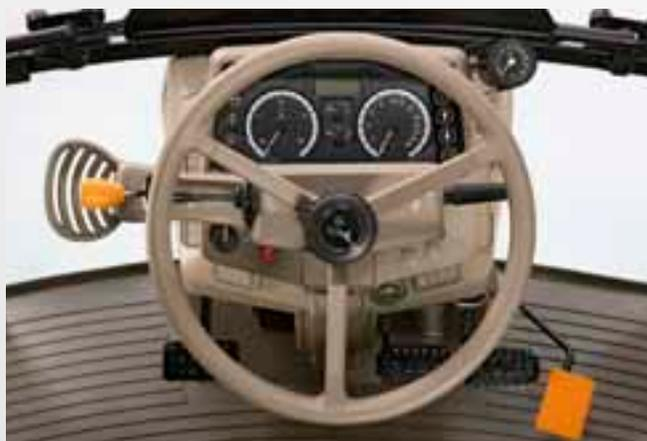
Dotato di grafica semplice, indicatori analogici e digitali precisi e controllo tattile, il quadro strumenti è stato ottimizzato per offrire una panoramica semplice di tutti i principali sistemi.
