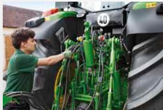
Con una portata fino a 114 l/min, il sistema idraulico ad alte prestazioni PFC (a pressione e flusso compensati) regola il flusso sulla base delle esigenze del sistema per risparmiare carburante e ottimizzare l'efficienza.
