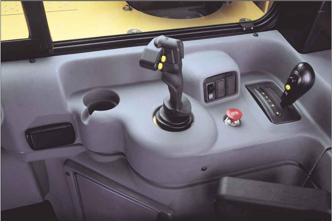
**Hydrauliksteuerhebel.** Im Vergleich zur früheren Mehrhebelsteuerung erfordert der neue Kombisteuerhebel mit logischem Bedienschema 25% weniger Kraftaufwand und 40% weniger Hebelbewegungen – eine deutliche Entlastung für den Scraperfahrer.
