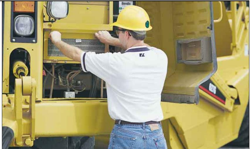
**Diagnoseanschluss.** Ein Laptop mit dem Cat PC-Programm *Elektroniktechniker* kann mit dem Diagnoseanschluss verbunden werden, um gespeicherte Fehler auszulesen. Darüber hinaus ermöglicht die Software weitere Prüfungen, wie zum Beispiel den Zylinderabschalttest.
