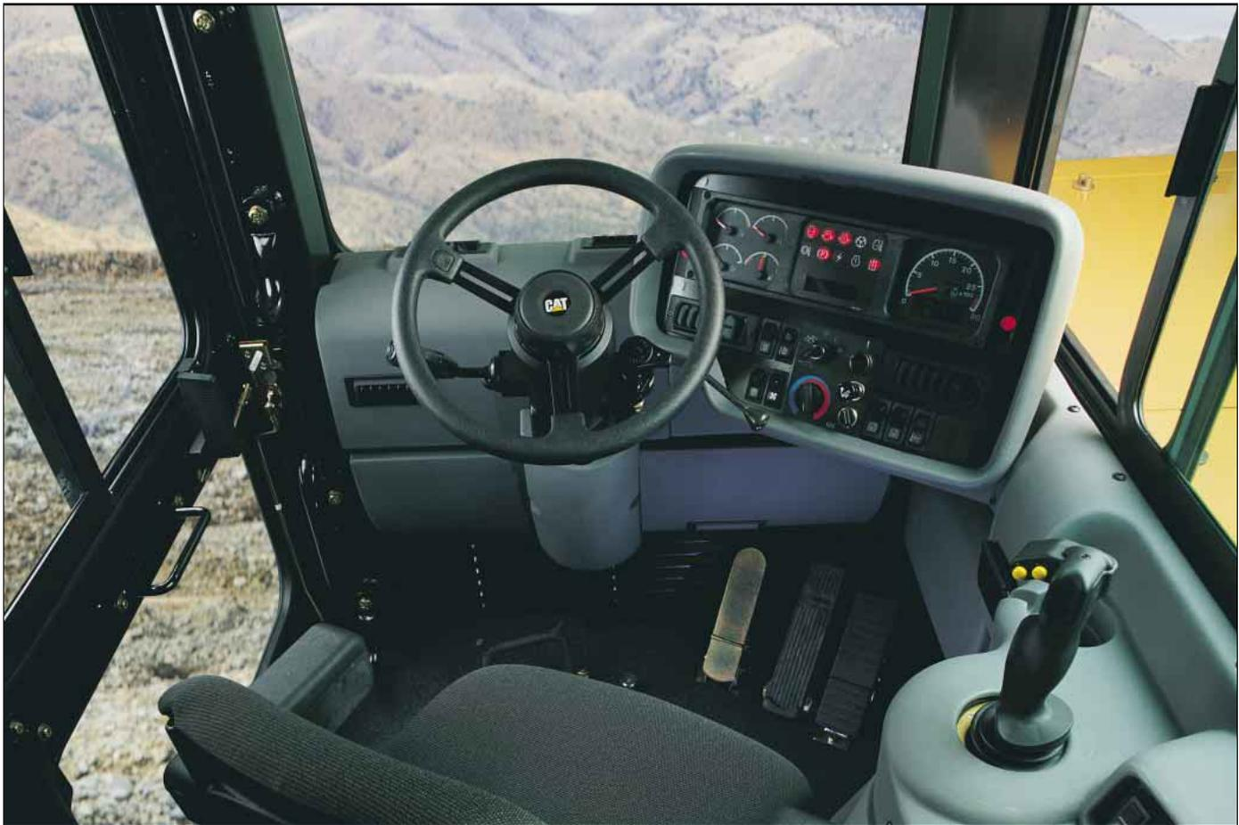
**Schalldämmung.** Die schalldämmte Kabine ruht auf elastischen Gummilagern, die Schall- und Schwingungsübertragungen weitgehend reduzieren.
