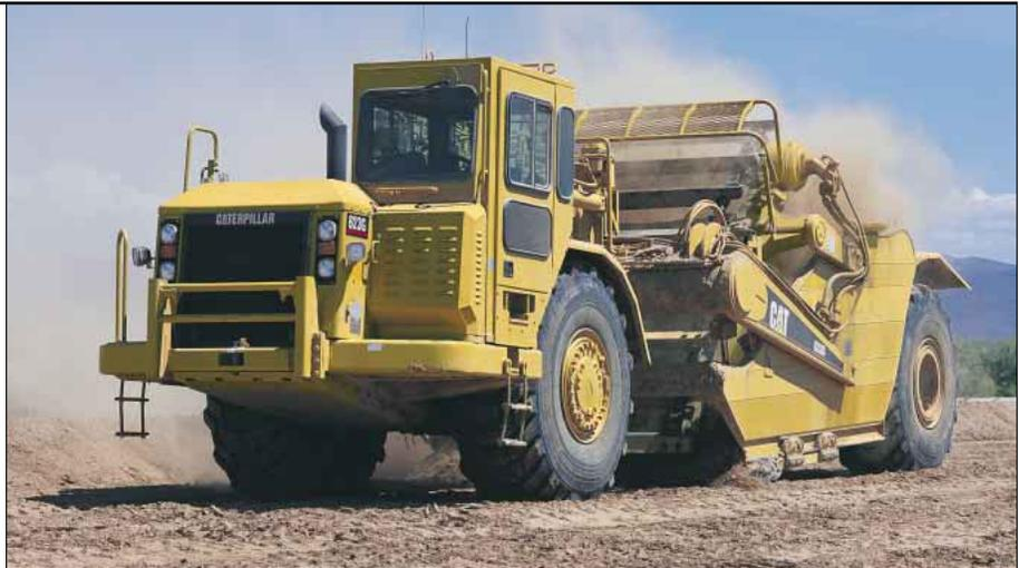
**Einpunkt Lagerung.** Die Lagerung des Elevators an einem einzigen Drehpunkt beschleunigt den Füllvorgang und verbessert die Ladeprofilkurve, sodass die zulässige Nutzlast des Kübels optimal ausgeschöpft werden kann.
