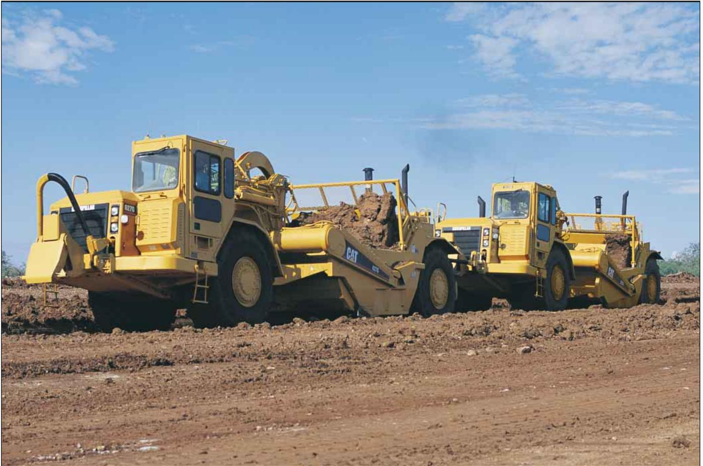
**Anwendung.** Der Push-Pull-Scraper 627G kann zusammen mit einer zweiten Maschine seines Typs zum Schürfen ohne Schubdozer eingesetzt werden. Besonders geeignet sind alle steifplastischen, tonig-lehmigen Böden, aber auch sandig-kiesige Böden mit einem gewissen bindigen Anteil. Von Einsätzen in Fels sollte man jedoch wegen des immensen Reifenverschleißes absehen.
