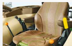
Comodità estrema I sedili pneumatici assorbono la maggior parte dei movimenti verticali.
