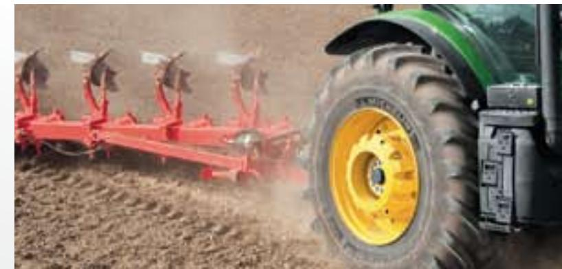
Dbejte na správné použití závaží – vyhnete se plýtvání paliva, utužování půdy, ztrátám výkonu a vyššímu opotřebení pneumatik.
