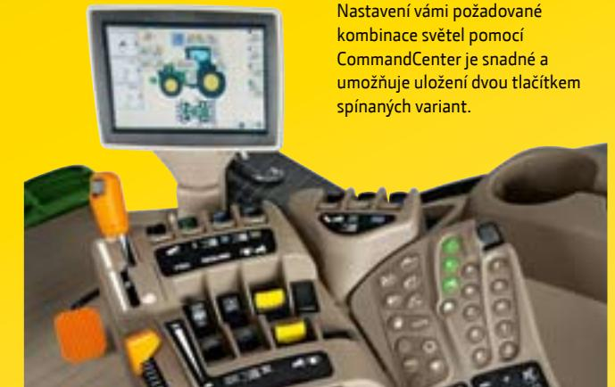
Nastavení vám požadované kombinace světel pomocí CommandCenter je snadné a umožňuje uložení dvou tlačítkem spínaných variant.
