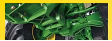
Guida fluida La sospensione TLS + a braccio triplo garantisce la massima trazione e un comfort di quida ottimale, specialmente in campi accidentati o strade dissestate.
