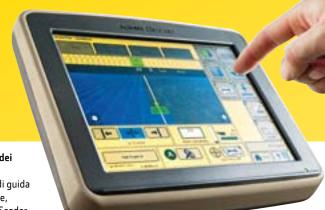
Il pacchetto Radio in versione Premium (opzionale), ulteriormente migliorato, mostra nome e numero di telefono delle chiamate in entrata sul display CommandCenter. È sufficiente premere un tasto per ricevere la chiamata. Il Display visualizza anche la rubrica per accedere direttamente ai numeri di telefono in memoria.
