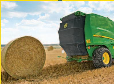
Die hintere Abdeckung wird automatisch geschlossen.
