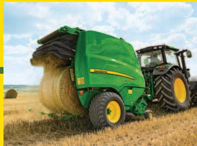
Die Abdeckung öffnet sich automatisch und der Ballen wird ausgeworfen.
