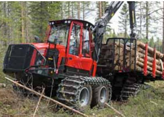
Die geniale HST-Kraftübertragung mit einer Grundzugkraft von 214 kN liefert dank des einzigartigen Zusammenspiels von Steuersystem und Motor eine optimierte Leistung.
