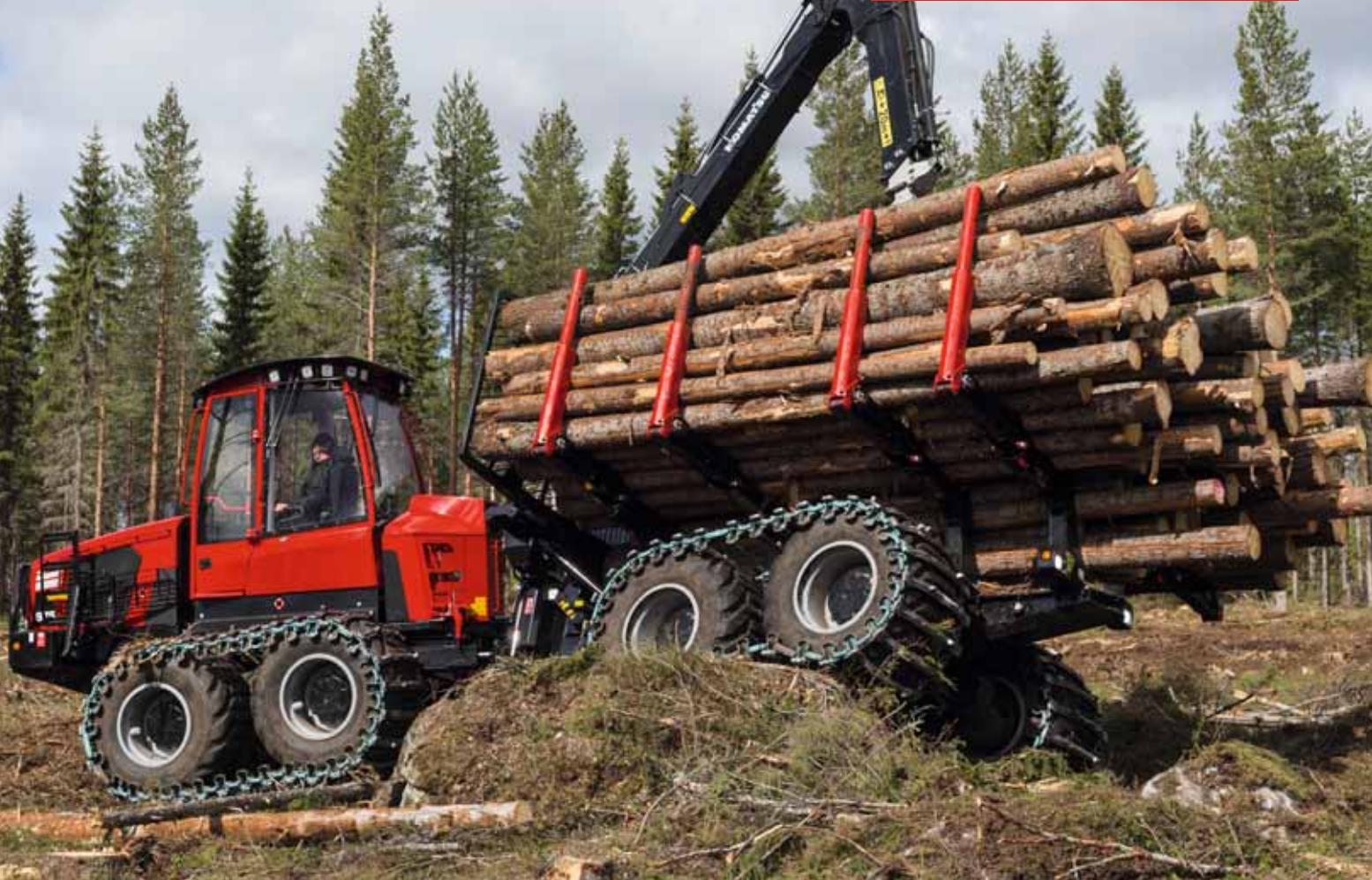
ein hohes Drehmoment bei niedrigen Drehzahlen und passt sich automatisch an veränderte Belastungen durch das Gelände, durch Hindernisse, Neigungen oder Kranlasten an. Dank der genialen Kraftübertragung ist das Zusammenspiel zwischen Motor, Getriebe und Steuersystem optimal, was eine überzeugende Geländegängigkeit garantiert.
