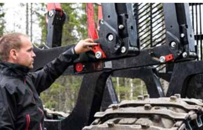
Mit FlexBunk kann die beeindruckend große Ladefläche in Breite und Höhe von der Kabine aus angepasst werden.
