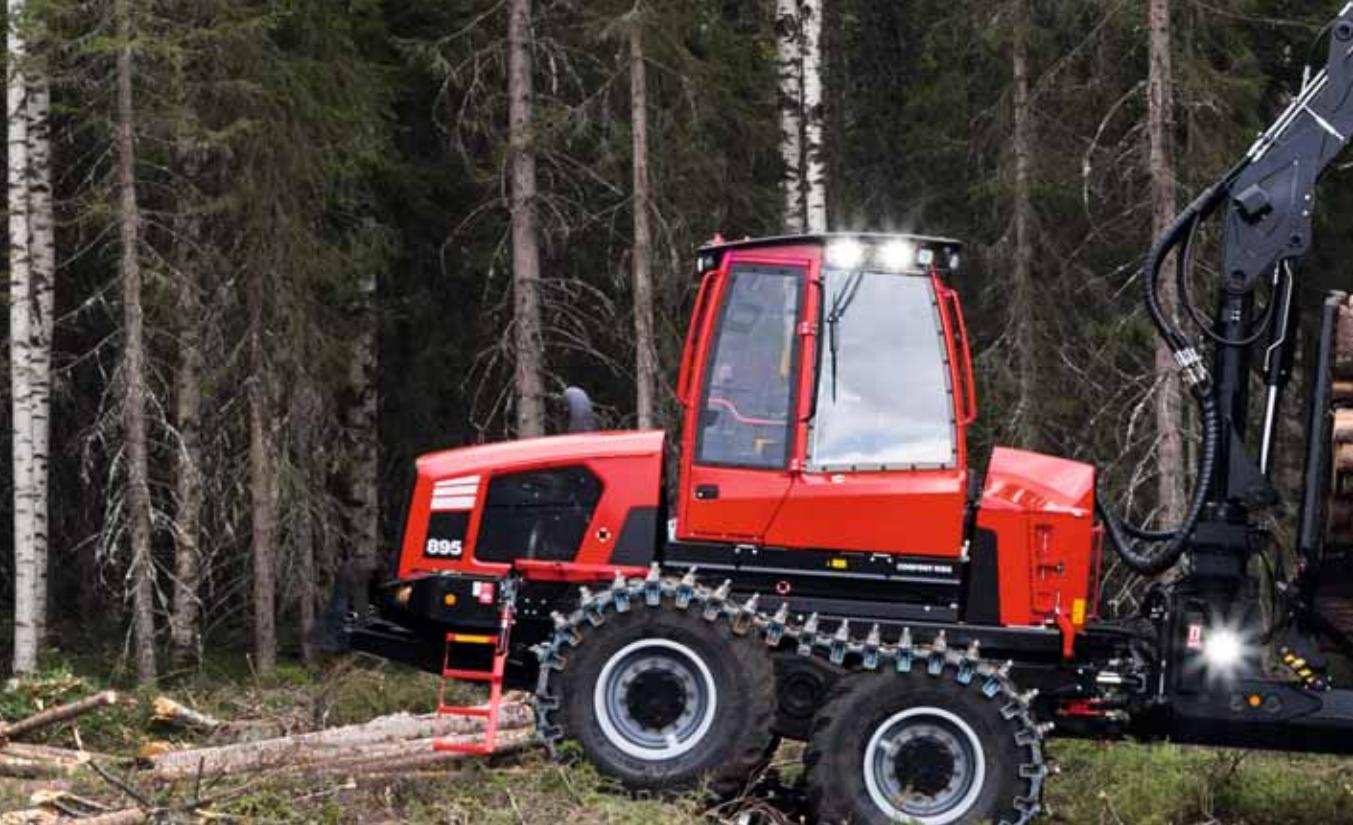
**Der Komatsu 895** ist wie geschaffen für produktive Kurzholztransporte. Jede Komponente ist für eine Ladekapazität von 20 t ausgelegt. Kein anderer Forwarder hat diese Klasse. Das ist ganz einfach so. Im Folgenden werden die wichtigsten Vorteile zusammengefasst:
