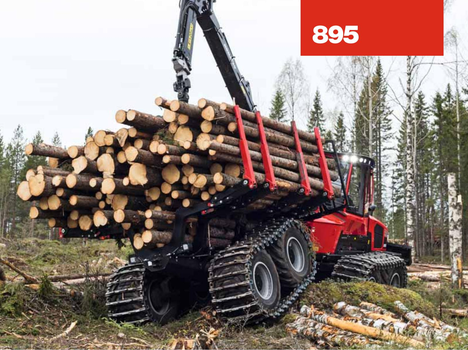
La grúa es grande, resistente y tiene altos pares de elevación y torsión. La grúa tiene una solución de columna y latiguillos segura, y brazo de articulación combinado de largo alcance con posicionamiento protegido de los latiguillos. Además, puede seleccionar una báscula de grúa fiable. Naturalmente, ProTec es una característica estándar.
