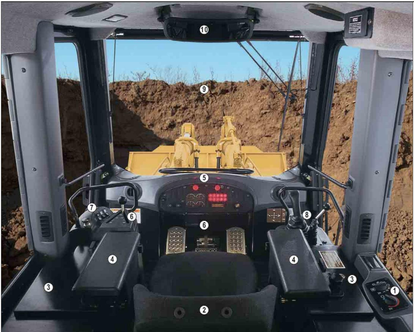
**1 Klimatisierung** – Serienmäßige Klimaanlage, Druckbelüftung, Frischluftfilter und zehn Luftdüsen sorgen bei jeder Witterung für einen wohltemperierten und staubfreien Innenraum.
