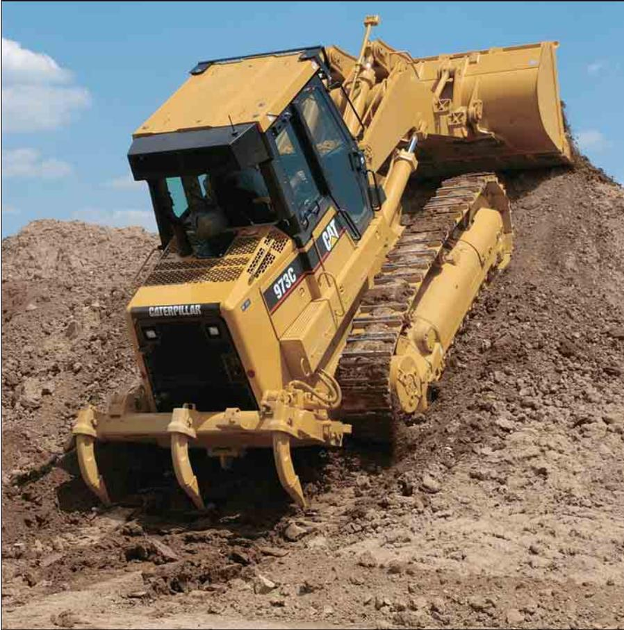
**Bedienung.** Dank des stufenlosen, hydrostatischen Fahrtriebs mit praktischer Einhebelbedienung für Fahrtrichtung und Geschwindigkeit kann sich der Fahrer hauptsächlich auf das Manövrieren der Maschine und das Positionieren des Arbeitsgerätes konzentrieren.
