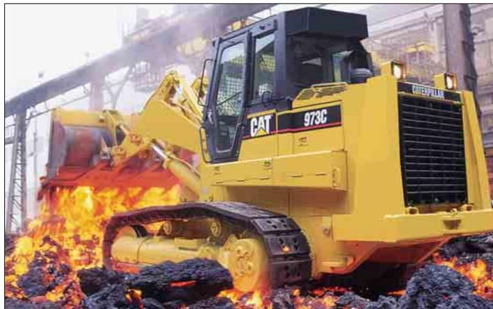
**Müllentsorgung/Abbruch.** Für Arbeiten auf Mülldeponien, in Müllumladestationen und bei Abbrucharbeiten kann der 973C mit einsatzspezifischer Ausrüstung geliefert werden. Diese Maschinenversionen eignen sich ideal für das Laden, Einbauen, Verdichten, Sortieren, Brechen und Zerkleinern von Material.
