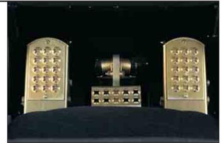
**Fahrpedale.** Der Positionswinkel der beiden Fahrpedale, die einen Stellweg von 23° aufweisen, kann von 35 bis 50° variiert werden, sodass eine individuelle Anpassung möglich ist.
