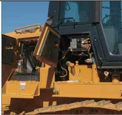
**Zugänglichkeit.** Groß bemessene Motorraumklappen erleichtern den Zugang zu Dieselmotor, Elektrokomponenten, Fahrtrieb und Starterbatterien. Hydrauliköl- und Kraftstofffilter sind gut erreichbar direkt nebeneinander angeordnet. Nach Ausbau der Bodenbleche in der Kabine kommt man mühelos an die innenliegenden Bauteile heran.
