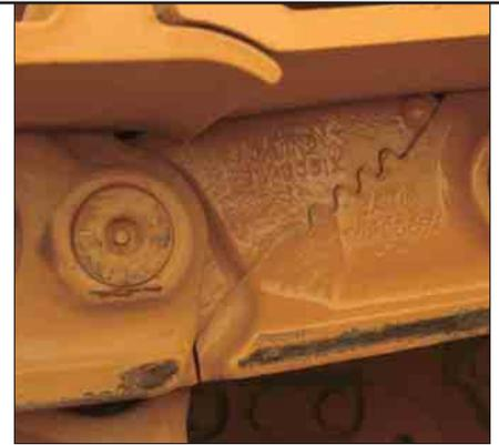
**Pendelaufhängung.** Beide Laufrollenrahmen können unabhängige, begrenzte Pendelbewegungen ausführen – ein konstruktiver Mehraufwand, der im Vergleich zu starren Laufwerken entscheidende Vorteile bringt: verringerte Stoßbelastungen, bessere Geländegängigkeit und größere Standsicherheit auf unebenem Boden.
