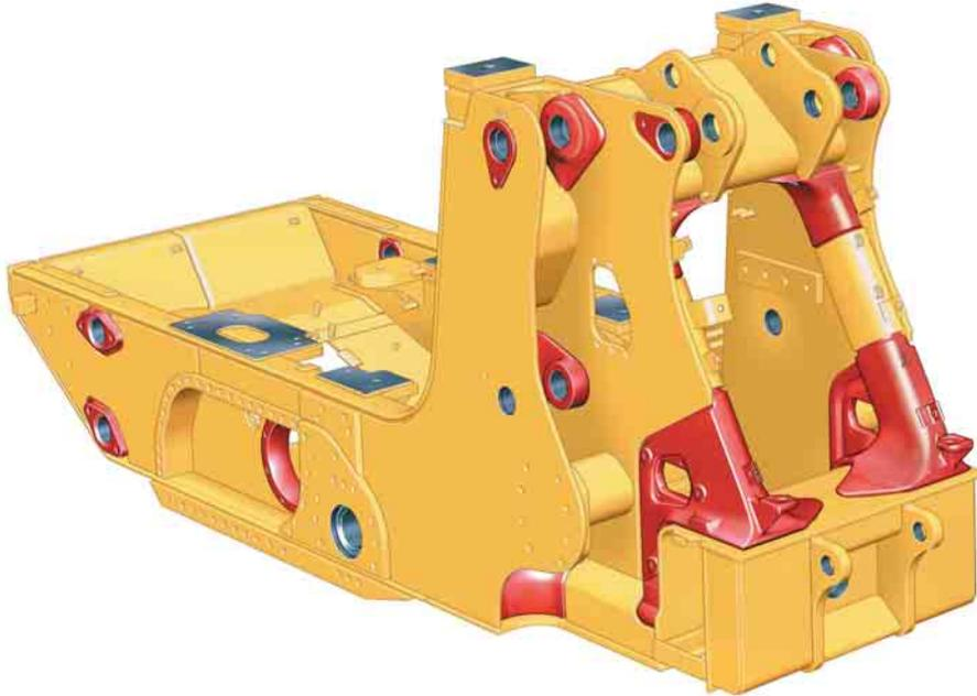
**Konstruktion.** Kastenprofil-Hauptrahmen und Laderahmenkonsole bilden eine robuste, verwindungssteife Einheit, die über die notwendige Stabilität in typischen Kettenlader-Einsätzen bei starken mechanischen Beanspruchungen der gesamten Maschine verfügt.
