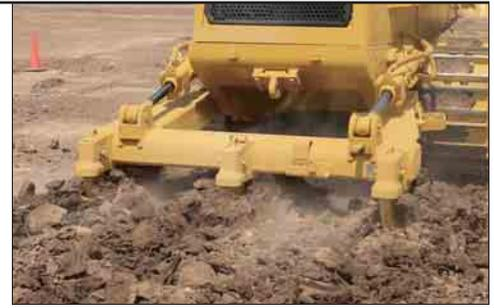
**Aufreißer.** Der Dreizahn-Radialaufreißer mit robuster Bolzenbefestigung an beiden Seiten des Maschinenhauptrahmens macht den 973C zur echten Allround-Maschine. Zwei seitlich angeordnete Zylinder bewirken das Heben und Senken. Die sechs Bolzendrehgelenke sind wartungsfrei ausgeführt.
