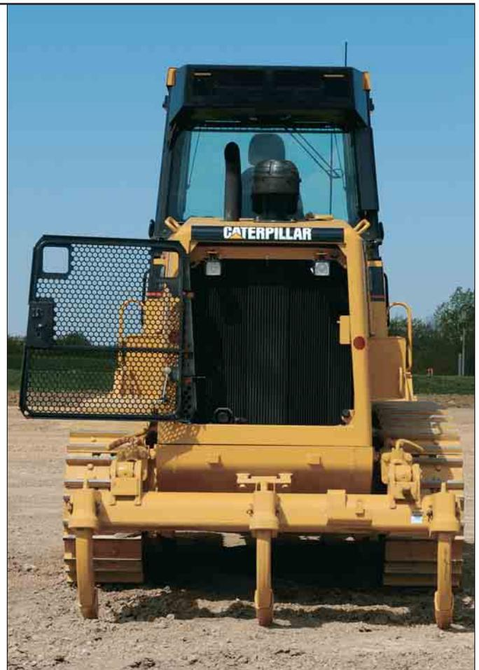
**Kühlsystem.** Ladeluft-, Wasser-, Hydrauliköl- und Hydrogetriebeölkühler sind in einer einzigen, flachen Einheit zusammengefasst. Aufgrund der grobmaschigen Ausführung zeichnen sich die Kühlernetze durch eine geringe Verschmutzungsneigung aus. Zudem lässt sich das Kühlerschutzgitter ausschwenken, um Reinigungsarbeiten zu erleichtern.
