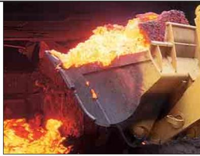
**Schlackeschaufel.** Insgesamt dickere Stahlbleche erlauben einen problemlosen Dauereinsatz dieser Spezialschaufel beim Abziehen heißer Hochofenschlacke in Hüttenbetrieben.
