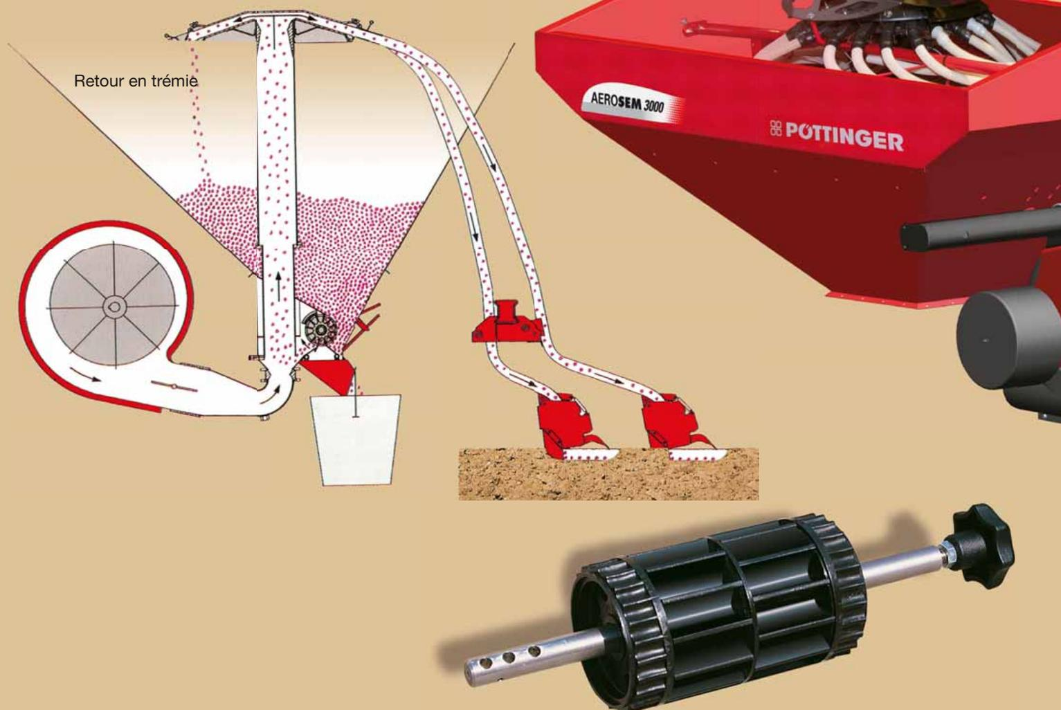
Le prix élevé des semences contraint les agriculteurs à bien maîtriser leurs coûts de production. La quantité de semence doit être dosée avec précision entre 1,7 et 350 kg/ha. Une dépose précise de la semence est la clé d'un succès économique en garantissant le rendement et en augmentant la qualité.
