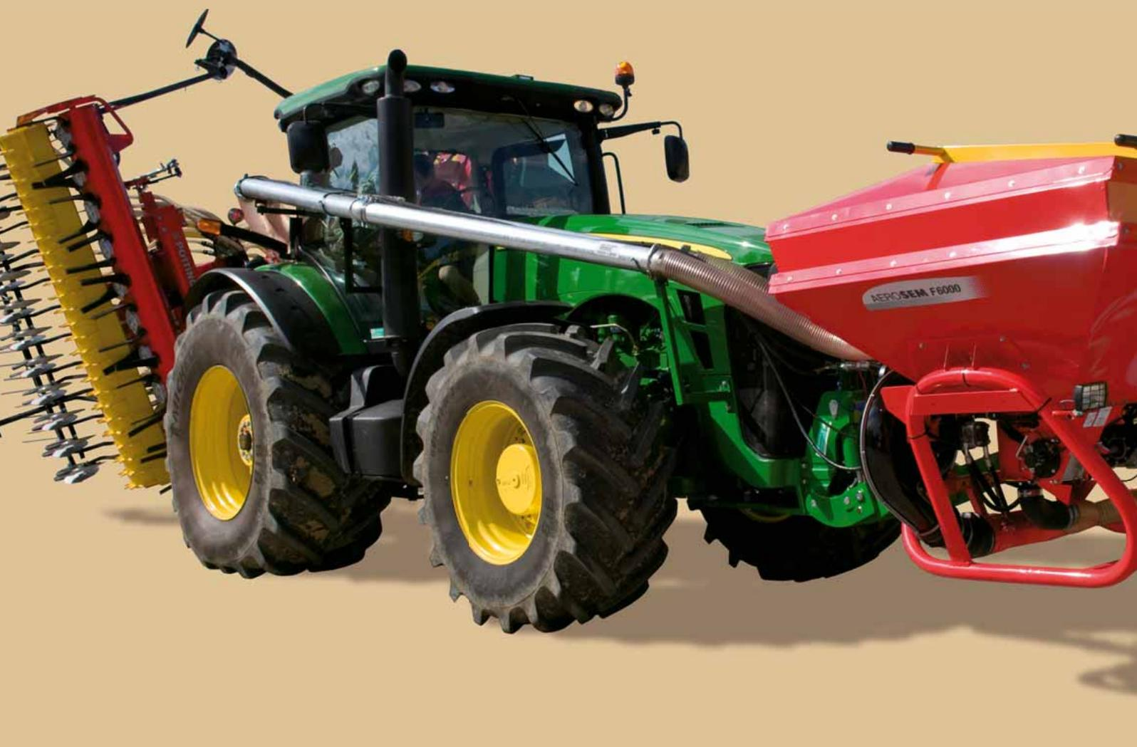
« Pour les semoirs à trémie frontale, l'équilibre des masses est amélioré ». La diminution de compactage des sols et la conduite en toute sécurité même dans les pentes, autant d'arguments en faveur de l'AEROSEM F de Pöttinger.
