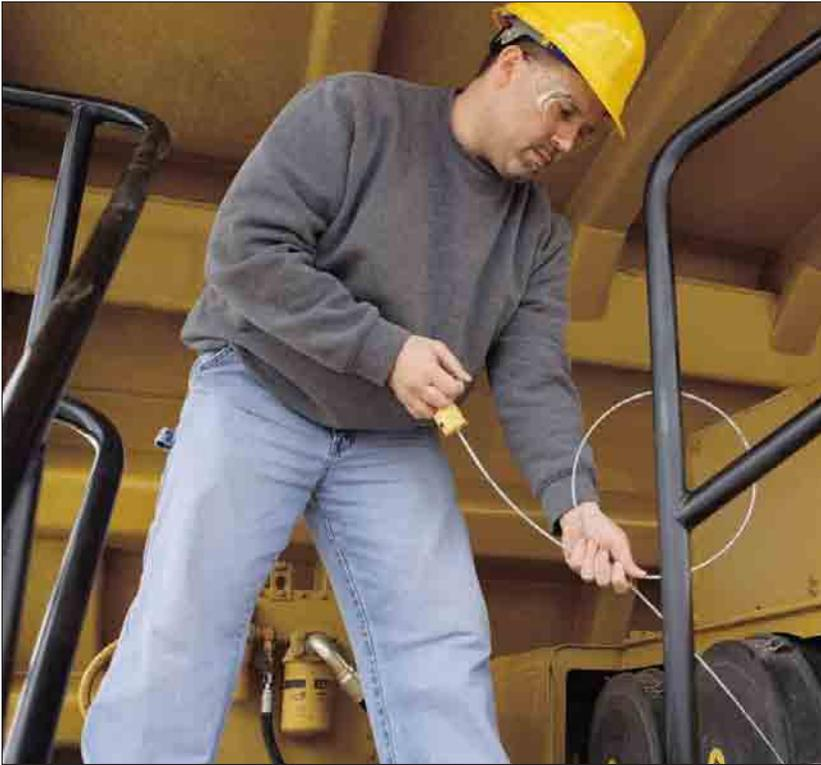
**Wartung.** Leicht zugängliche Wartungsstellen und verlängerte Wartungsintervalle (Motorölwechsel nur noch alle 500 Stunden) reduzieren den Zeitaufwand und steigern die Verfügbarkeit der Maschine.
