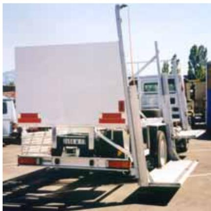
2 x DH-VA para carga y descarga lateral de bombonas de gas, cajas de botellas, bidones, etc.
