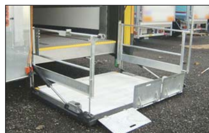
S751 Barreras de seguridad montadas sobre las guías corredizas de plataforma en lugar de encima del plato
