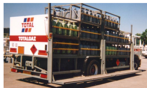
DH-VA mit verbreiteter Plattform, seitlich in 2 Sektionen montiert um eine maximale Flexibilität möglich zu machen
