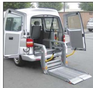
**S953** Plateau ouvrant verticalement et automatique pour libre accès à l'intérieur de la carrosserie (modèle illustré = DH-P20, le DH-P21 n'a pas de barrières de sécurité)
