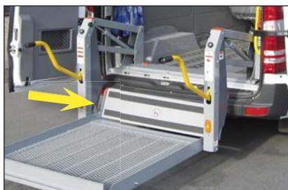
**S955** Tôle de liaison automatique montée sur le plateau (barrières latérales = non standard)
