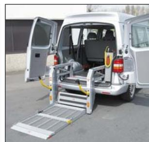
**S957** Plateau pliant horizontalement pour montage dans fourgon non surélevé et/ou pour dégager la vision au vitres des portes (modèle illustré = DH-P20, le DH-P21 n'a pas de barrières de sécurité)
