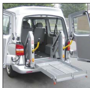
S953 Pianale ripiegabile verticalmente che consente un passaggio completamente libero da ostacoli (modello riportato = DH-P20, DH-P21 esclude le barriere di sicurezza)
