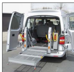
S957 Piattaforma ripiegabile per ridurre l'altezza di montaggio prevista e per assicurare al conducente la massima visibilità attraverso le porte posteriori del veicolo (modello riportato = DH-P20, DH-P21 esclude le barriere di sicurezza)
