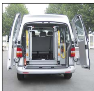
S953 Pianale ripiegabile verticalmente che consente un passaggio completamente libero da ostacoli (modello riportato = DH-P20, DH-P21 esclude le barriere di sicurezza)
