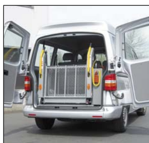
S957 Piattaforma ripiegabile per ridurre l'altezza di montaggio prevista e per assicurare al conducente la massima visibilità attraverso le porte posteriori del veicolo (modello riportato = DH-P20, DH-P21 esclude le barriere di sicurezza)
