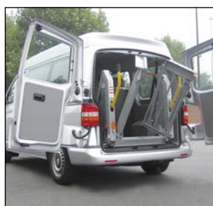
S953 Pianale ripiegabile verticalmente che consente un passaggio completamente libero da ostacoli (modello riportato = DH-P20, DH-P21 esclude le barriere di sicurezza)
