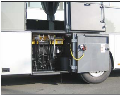
S981 DH-RB avec déplacement latéral hydraulique pour les situations de montage où l'ouverture de la porte est déportée par rapport à l'espace de montage du hayon
