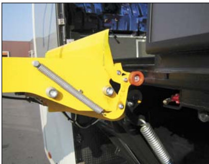
S983 Clapet garde-pied automatique sur l'avant de la plateforme
