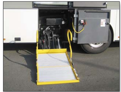
S981 DH-RB avec déplacement latéral hydraulique pour les situations de montage où l'ouverture de la porte est déportée par rapport à l'espace de montage du hayon
