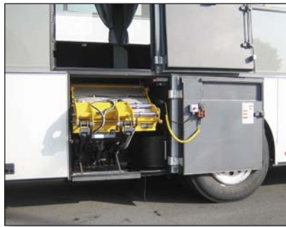
S981 DH-RB avec déplacement latéral hydraulique pour les situations de montage où l'ouverture de la porte est déportée par rapport à l'espace de montage du hayon
