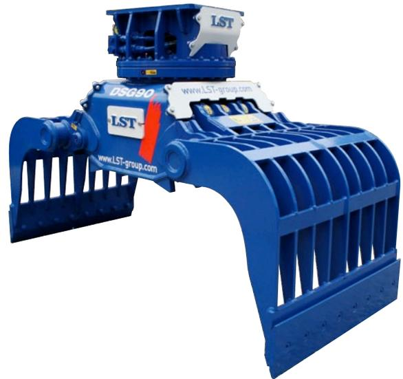
Ein innenliegender, durch Überdruckventile geschützter Hydraulikmotor treibt den Drehkranz an. Alle Modelle der Serie DSG verfügen über 360° Endlosdrehung und hohe Stabilität. Bereits Modelle mit geringem Einsatzgewicht sind mit einem robusten Drehkranz mit niedriger Bauhöhe ausgestattet. Ein doppelt gelagerte Drehkranz ermöglicht exaktes Positionieren bei Geräten ab 15 t Baggergewicht.
