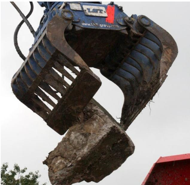
Der schmale, niedrige Grundkörper besticht durch große Öffnungsweite. Der Öffnungswinkel von 90° bewirkt ein ideales Verhältnis von Kraft und Inhalt. Die Abbruchrippen sind extrem verwindungssteif und tragfähig. Der optimale Abstand der Rippen ermöglicht auch den gezielten Abbruch von Mauerwerk. Durch Anschläge wird dauerhaft exaktes Schließen der Schalen für präzises Arbeiten erreicht.
