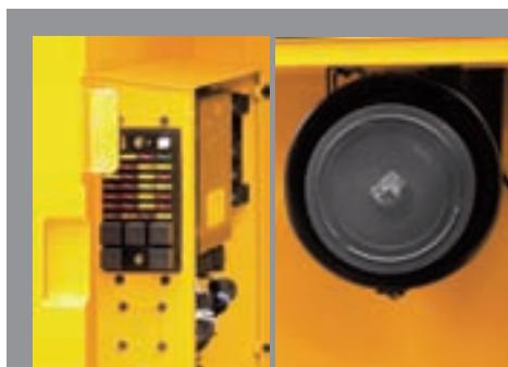
**Centralización de la caja de control eléctrico y montaje del filtro de aire de cambio fácil**
