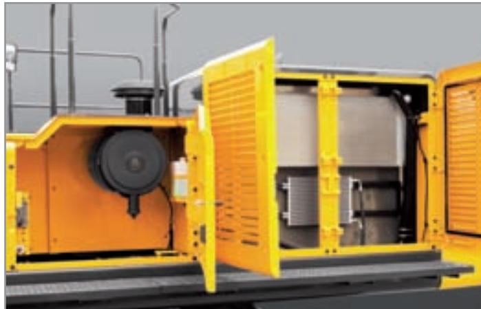
**Cubierta lateral con giro izquierdo y derecho de tipo abierto**
