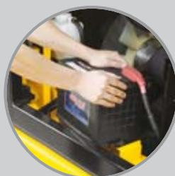
**Schwenkbar installierte Batterie**
