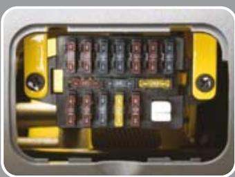
**Gut erreichbarer, kompakter Sicherungskasten für einfache Wartung**
