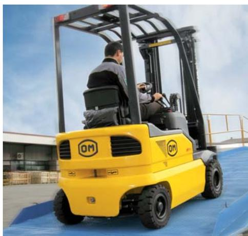
Anche sulle rampe i carrelli della famiglia XE garantiscono una grande facilità e comodità di utilizzo. In presenza di pendenze, infatti, il carrello si ferma automaticamente al rilascio dell'acceleratore; dopo alcuni secondi di fermo la macchina inizia la discesa a velocità controllata automaticamente.
