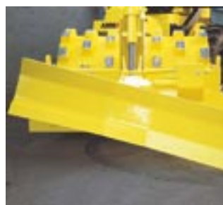
Planierschild mit hydr. Tilteinrichtung
