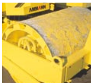
Flexibilität durch optionale Glattmantelsegmente
