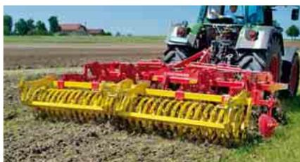
superficiale del terreno si arricchisce di sostanze organiche, tanto più migliora la filtrazione del terreno. I coltivatori SYNKRO, con vomeri ad alette smontabili, sono particolarmente indicati per questo tipo di lavorazione. La profondità di lavoro deve essere di circa 10 cm. Nel caso di semina di foraggi, si possono integrare contemporaneamente colture intercalari.
