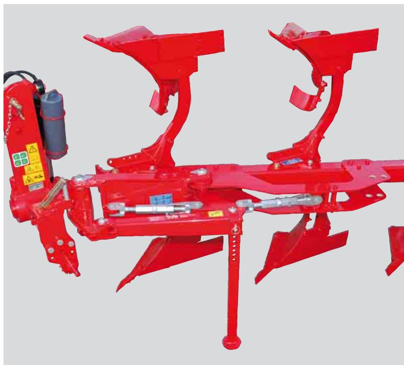
**Sistema di regolazione SERVOMATIC** per aratri SERVO con regolazione meccanica della larghezza di lavoro
