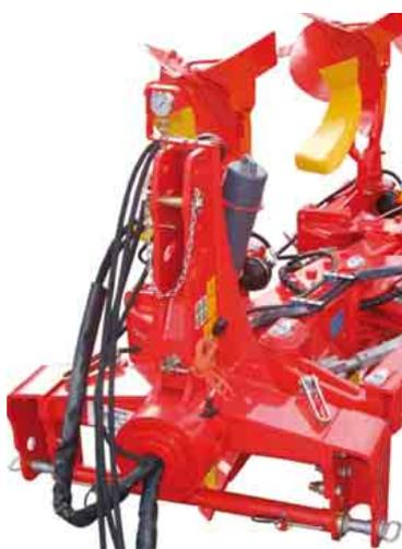
**Riempimento centralizzato con manometro di serie** su tutti i modelli **SERVO NOVA**.
