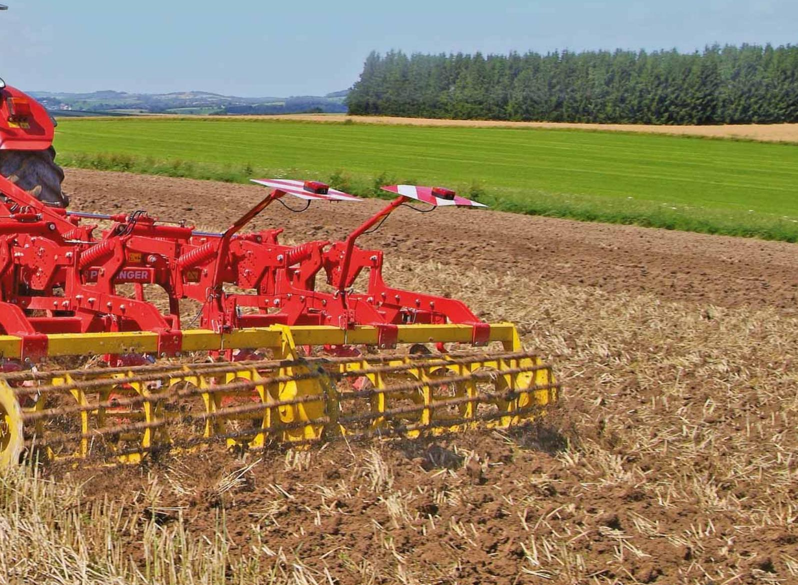
I coltivatori SYNKRO K sono dotati di un ribaltamento idraulico con bloccaggio meccanico per il trasporto su strada.
