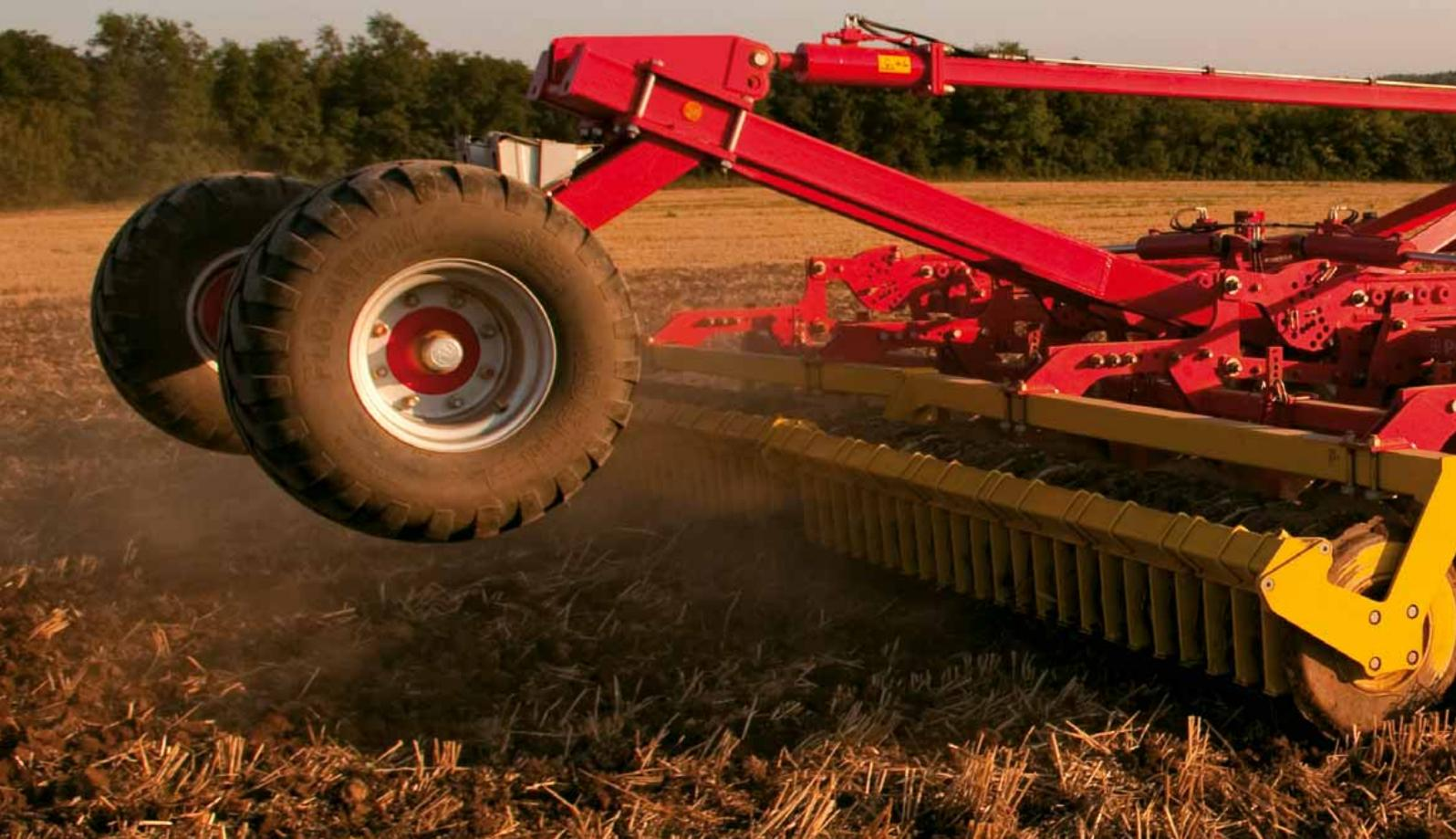
Un carrello di trasporto idraulico supporta la macchina e non sovraccarica l'assale anteriore del trattore. Il dispositivo di sollevamento posteriore è soggetto a meno sollecitazioni.
