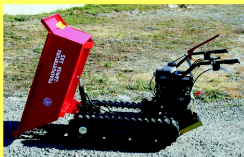
Pianale dumper con ribaltabile idraulico Dumper bed with hydraulic tipping Plateau dumper avec basculement hydraulique Dumperpritsche und Hydr. Kippung
