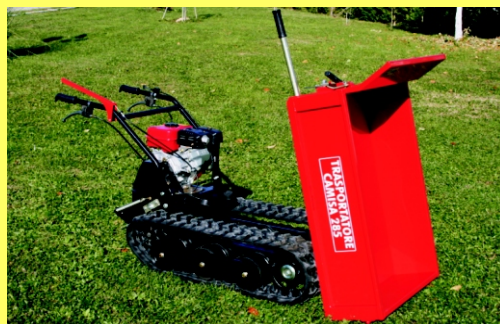
Pianale di carico con ribaltabile manuale Loading platform with manual tipping Plateau avec basculement manuel Ladepritsche mit manuell kippar
