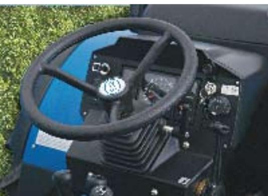
Darüber hinaus dreht sich das Führermodul (Sitz - Steuer - Armaturenbrett) in der reversiblen Version **Vithar EP** in nur 5 Sekunden praktisch und sicher, ohne irgendeine Verbindung abtrennen zu müssen.
