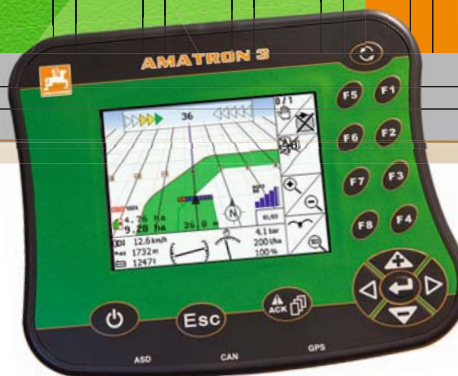
AMATRON 3 con GPS-Switch para la AD-P y la Avant
