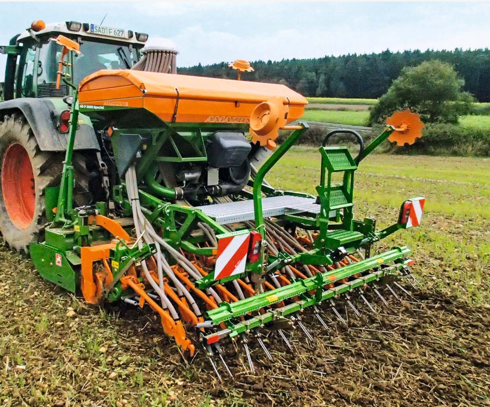
AD-P 3000 Special 850; Ancho de trabajo de 3 m con rejas WS
