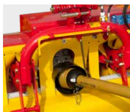
Rotation prise de force à gauche
