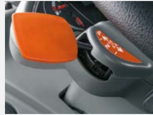
NEU: REVERSHIFT Wendeschalthebel mit elektronischer Feststellbremse verfügbar
