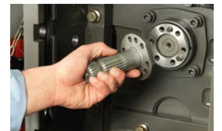
Einfacher Wechsel der Zapfwellenstummel
