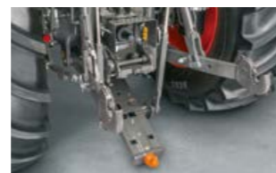
Alternativ zum Anhängbock ist eine Hitchhakenkupplung verfügbar.
