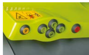
Externe Bedienelemente für den Heckkraftheber, die Zapfwelle und ein wählbares Steuergerät (nur CEBIS)
