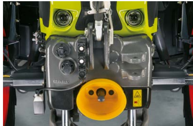
Am Frontkraftheber befinden sich Anschlüsse für ein Steuergerät und einen freien Rücklauf.
