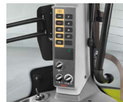
Zapfwellengeschwindig-keiten und elektronische Heckkraftheberregelung am B-Holm einstellbar
