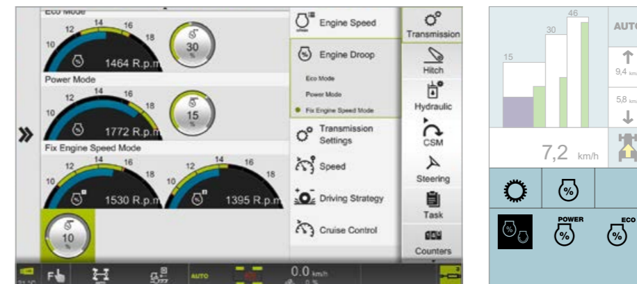
Einstellung der Motordrückung für „Eco“ und „Power“, sowie den Motordrehzahlspeicher
