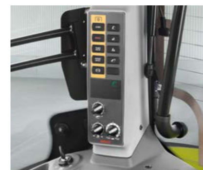
Zapfwellengeschwindigkeiten und elektronische Heckkraftheberregelung am B-Holm einstellbar
