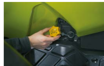
Ölstandskontrolle und Nachfüllen bei geschlossener Haube möglich
