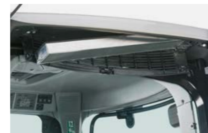
Leichter Zugang zum Kabinenluftfilter am Kabinendach
