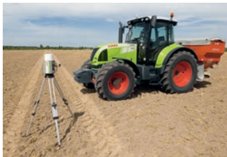
El receptor GPS del sistema BASELINE HD. Éste contiene un receptor telecontrolado adicional para la señal de referencia.
