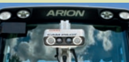
Telecamera CAM PILOT montata frontalmente.
