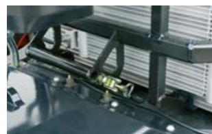
Punti di lubrificazione dell'assale anteriore davanti al gruppo radiatori per raggiungerli più facilmente
