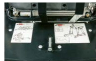
Sotto il cofano motore è disponibile un programma di lubrificazione per semplificare la manutenzione.
