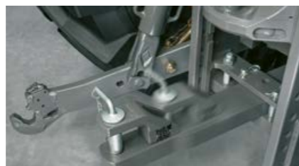
Nelle versioni con barra di traino sono possibili più posizioni. La posizione migliora la manovrabilità.
