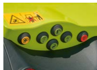
Comandi esterni per la presa di forza posteriore su entrambi i parafanghi
