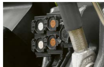
In combinazione con il sollevatore anteriore sono disponibili fino a quattro innesti idraulici e una linea di ritorno libera sulla parte anteriore. Soluzione ideale per attrezzature montate frontalmente.
