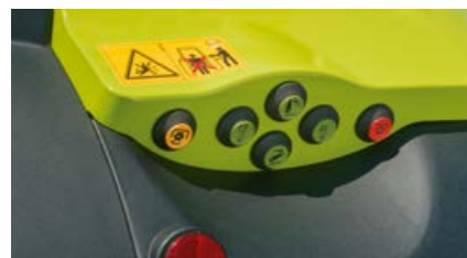
Comandi esterni per sollevatore posteriore, presa di forza e un distributore a scelta (solo CEBIS)
