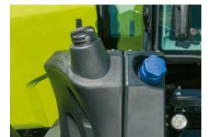
Serbatoio carburante da 455 l con serbatoio interno di 42 l per l'urea
