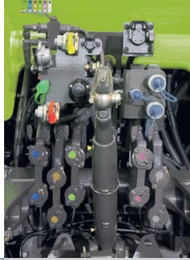
Réglage aisé des fonctions des distributeurs grâce au CEBIS.
