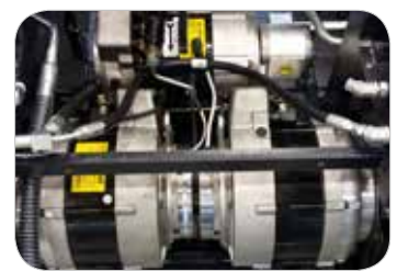
Doppio motore trazione e motore pompa AC: potenti, chiusi con isolamento IP43
