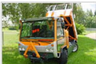
Kippbrücke mit einer Breite von 1700 mm kann ordentlich zugeladen werden.
