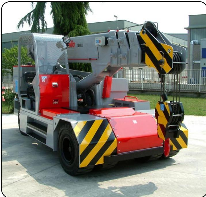
**FLECHE:** en tôle d'acier de qualité, pliées et soudées, à quatre sections télescopiques hydrauliques sur glissières en nylon.
