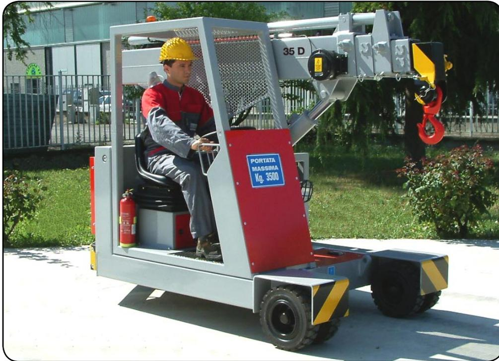
**CHASSIS:** construit à partir de plaques d'acier pliées et soudées, de haute qualité et contrepoids intégré.
